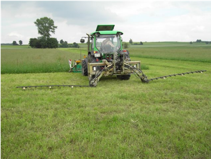
Foto: Moderne Doppelmesser-Mähwerke gibt es für den Heck- und Frontanbau und in Arbeitsbreiten über 10 m (Schmetterlingsmäherwerk)
